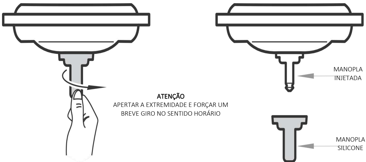
Figura 49 - Desacoplando a manopla de silicone
